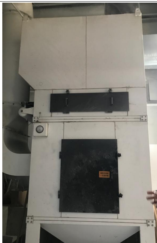
二级滤筒除尘器
